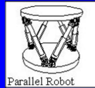
ベースとメカニカルインターフェースとの間の機械構造に複数の動力伝達経路をもつ
