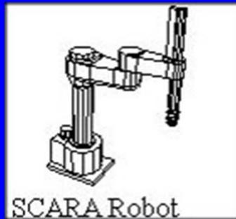
腕の機械構造が、平行軸の回転ジョイントをもち、軸に直交する方向の剛性低い
