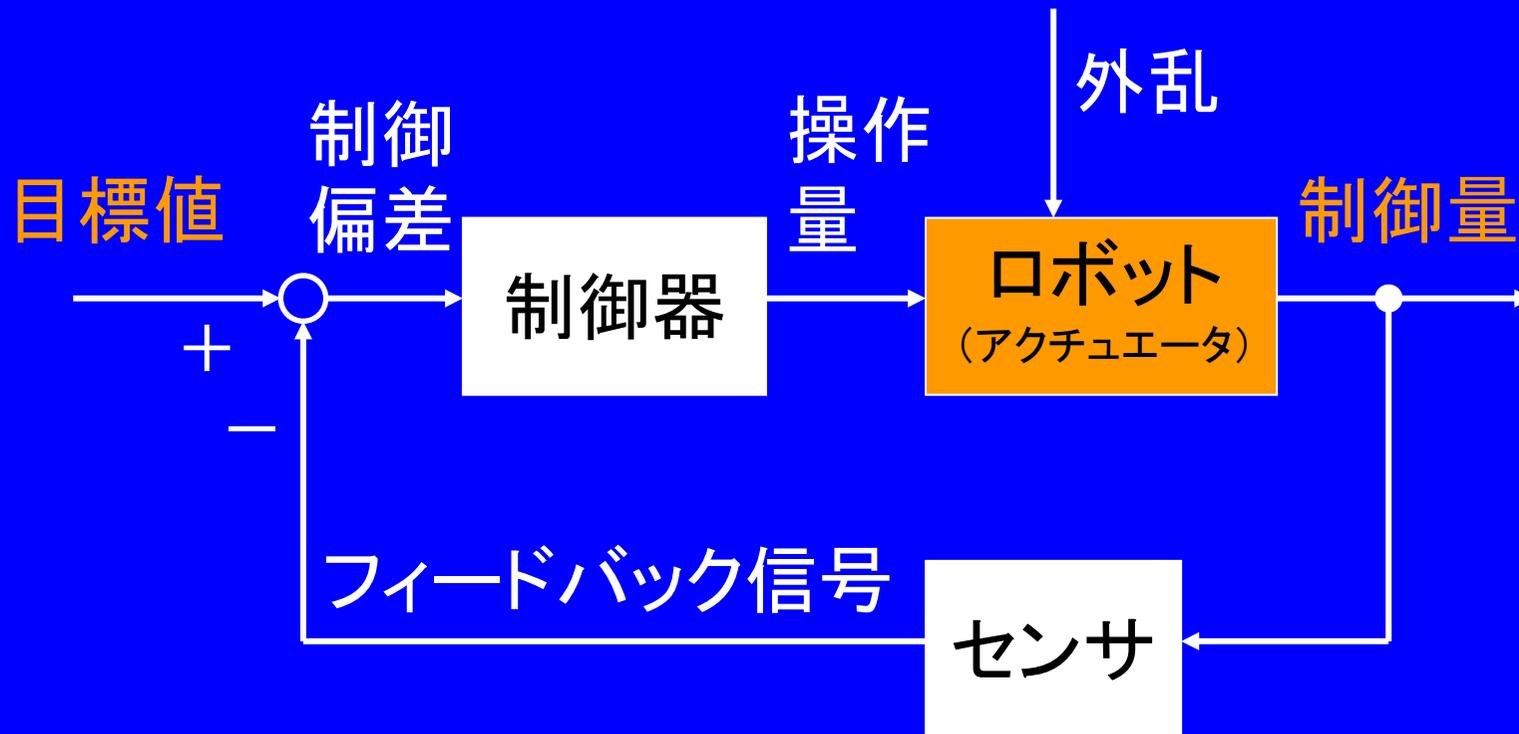
制御対象(ロボット)への入力を操作して、
